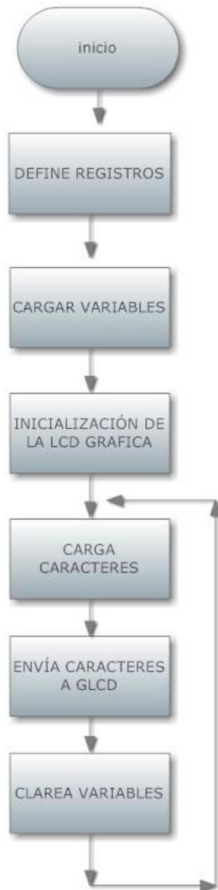
Figura 58. Diagrama de flujo del algoritmo para la implementación de la LCD
