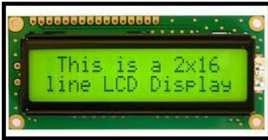
Figura 10. Pantalla LCD alfanumérica con resolución de 2X16
