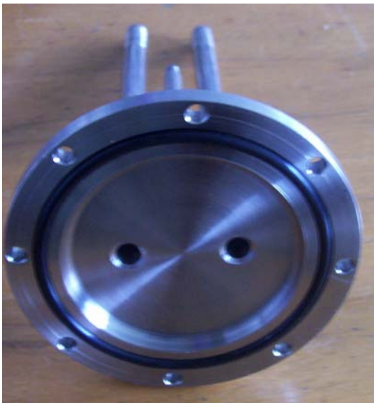
Figura 34: Cámara de refrigeración y O Ring
