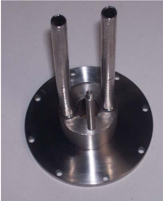
Figura 33: Cámara de refrigeración.
