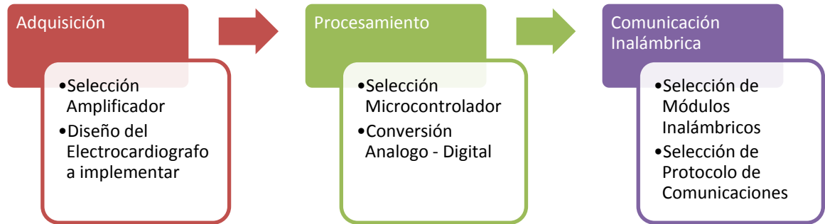
Figura 12. Diagrama de bloques general del proceso de la señal ECG.
