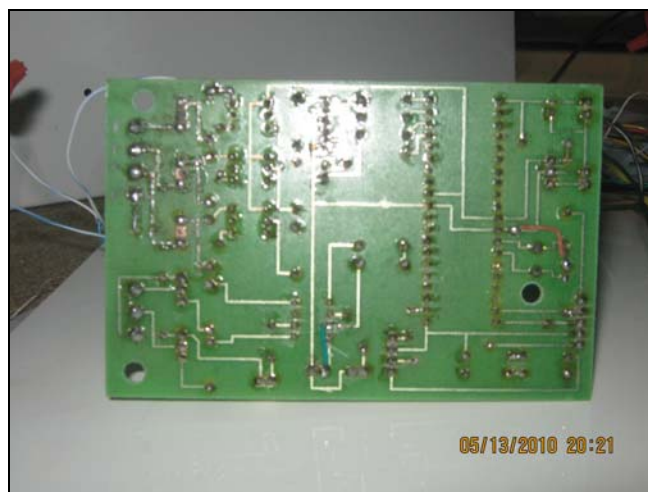
Foto 6. Circuito de control cara inferior
