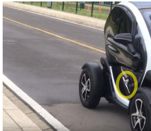
Imagen 13: Micrófono de medición acoplado al vehículo automotor eléctrico Renault Twizy (plano lejano).
