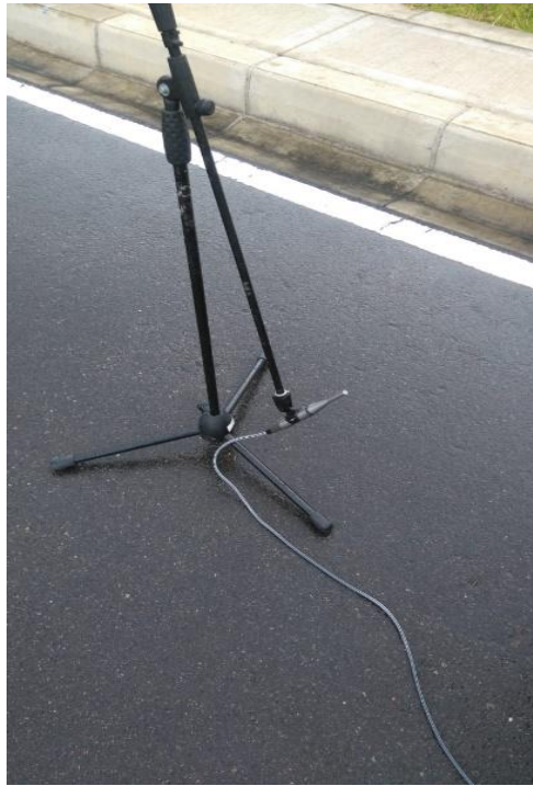
Imagen 14: Montaje de micrófono Earthworks M30. Medición de ruido de escape para vehículo automotor a combustión.
