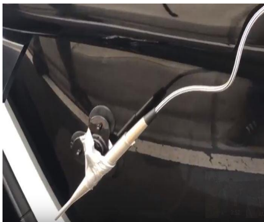
Imagen 12: Micrófono de medición acoplado al vehículo automotor eléctrico Renault Twizy (plano cercano)
