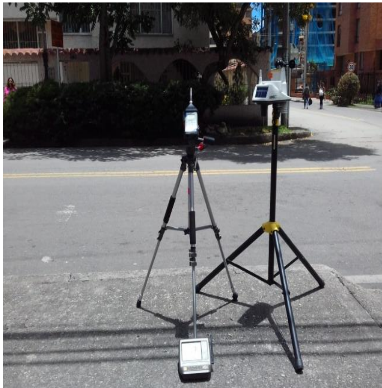
Imagen 8: Evaluación de ruido ambiental de ruido por tráfico vehicular en zona urbana de la ciudad de Bogotá; Instrumentos de medición: sonómetro Svantek 943 y estación meteorológica Davis Vantage Vue.
