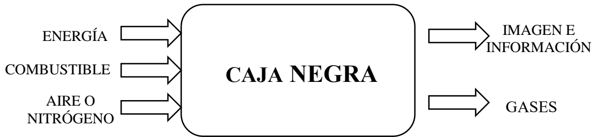
Figura 23. Diagrama Caja Negra mostrando las entradas de energía y materia, y la salida de información y materia de desecho. Fuente: Autores.
