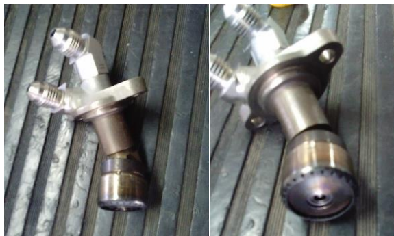
Figura 26. Inyector de un motor Garrett TPE 310. Contiene entrada de combustible y entrada de aire a presión.
