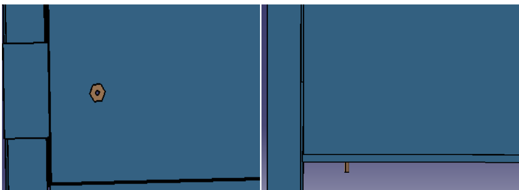
Ilustración 26 Drenaje de los tanques
