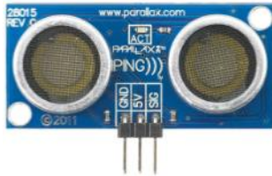
Figura 11: Sensor ultrasónico ping))) parallax. (PARALLAX, 2014)
