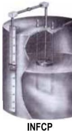
Figura 2: Indicador de nivel flotante. (SCHILLIG, 1992)
