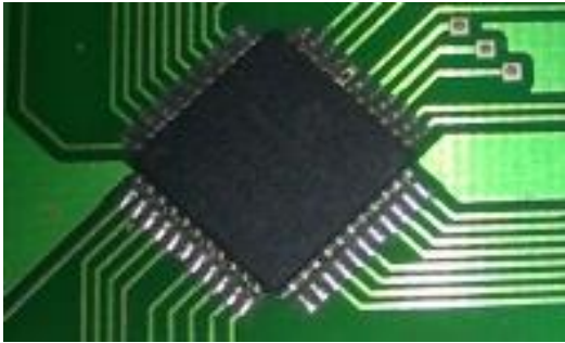
Figura 17: Microcontrolador PIC 18f4550 SMD
