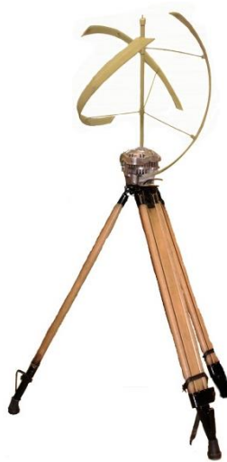
Figura 42. Ensamble de la turbina ( c = 0.03m ) con el alternador, primera práctica
