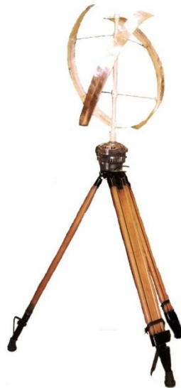
Figura 44. Ensamble de la turbina ( c = 0.05m ) con el alternador, segunda práctica
