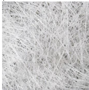
Figura 27 Fibra de vidrio tipo E, Tela mat
