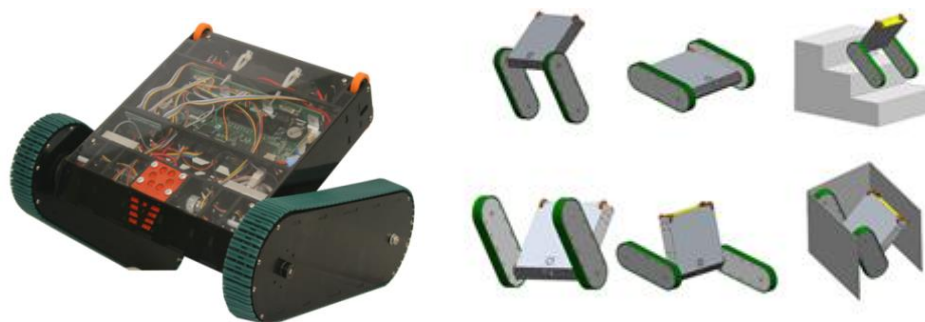
Figura 9. Switchblade, robot multimodal diseñado por estudiantes de la UCSD para control de desplazamientos. 6
