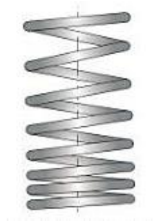
Figura 33. Muelle para válvulas
