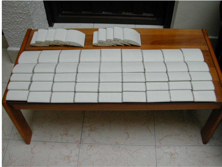
Figura 39. Terminación de perfiles en icopor
