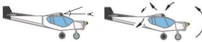
Figura 35: Representación de C_{m\dot{\alpha}}
