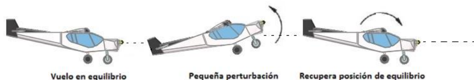
Figura 4: Comportamiento de una aeronave estable estáticamente
