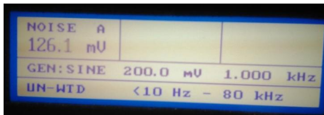
FIGURA 53. Nivel de ruido sin señal de entrada sobre carga de 8 \Omega .
