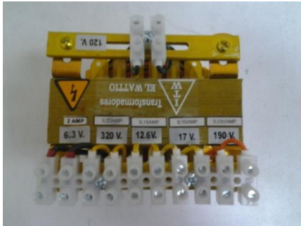
FIGURA 99. Transformador fuentes de alimentación
