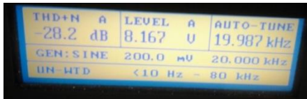
FIGURA 94. Preamplificador. Nivel de salida, THD + N a 20 kHz
