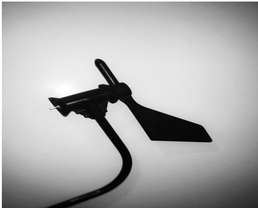
Figura. 32. Veleta de viento analógica. Fuente propia
