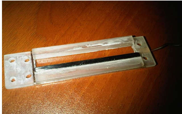
Figura 5.11 Establecido el primer iman en el chasis
