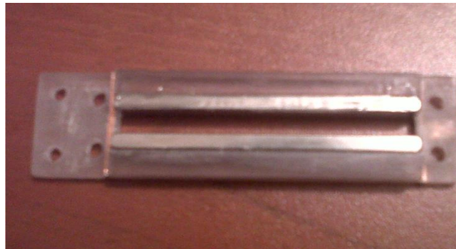
Figura 5.13 Transductor en la fase final con los imanes ya fijados en el chasis
