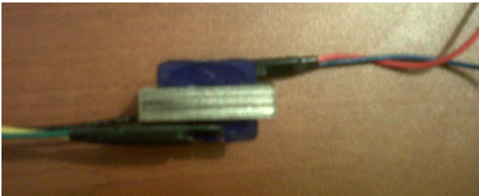
Figura 5.18 Transformador implementado en el microfono de cinta RMX-1.
