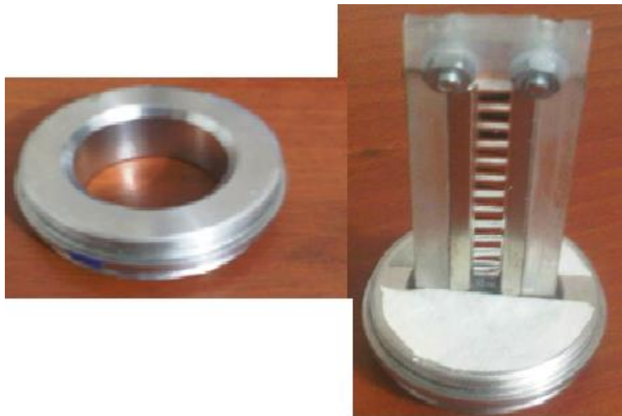
Figura 5.22 Resultado en acero inoxidable de la union y encajando el transductor
