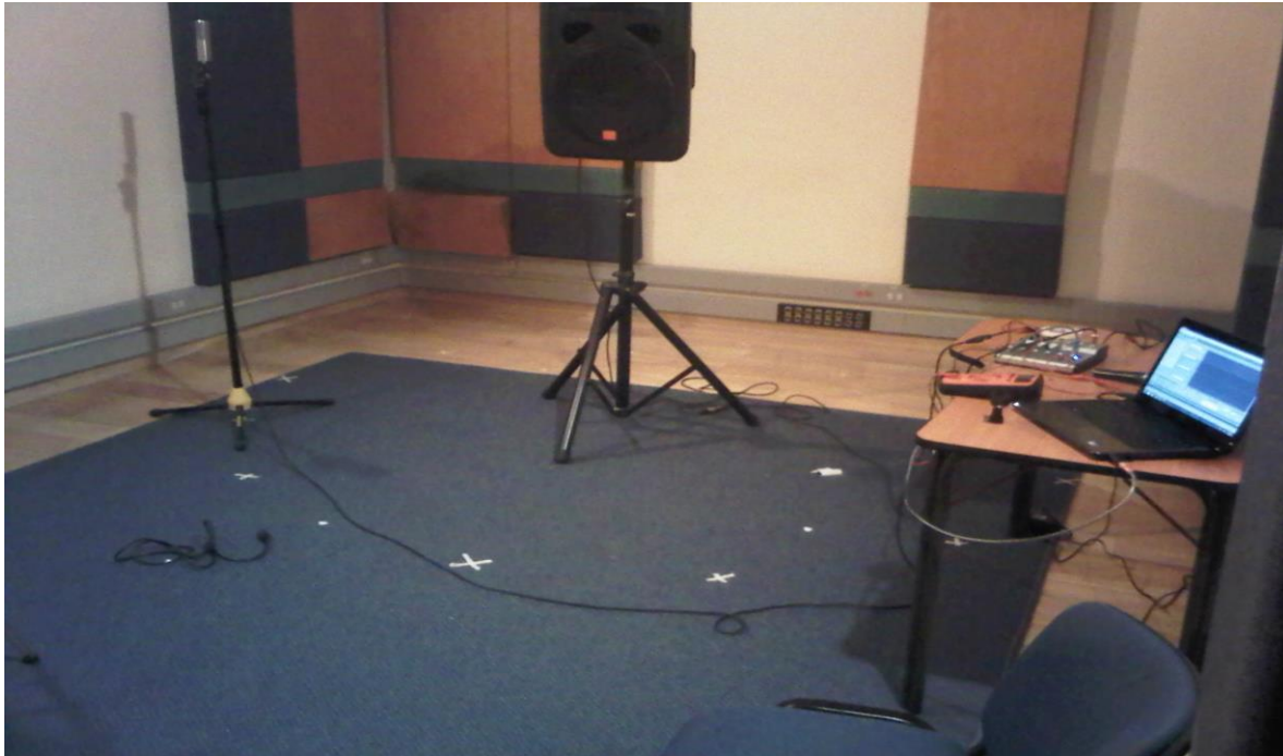
Figura 5.27 Medición del Patrón polar del micrófono
