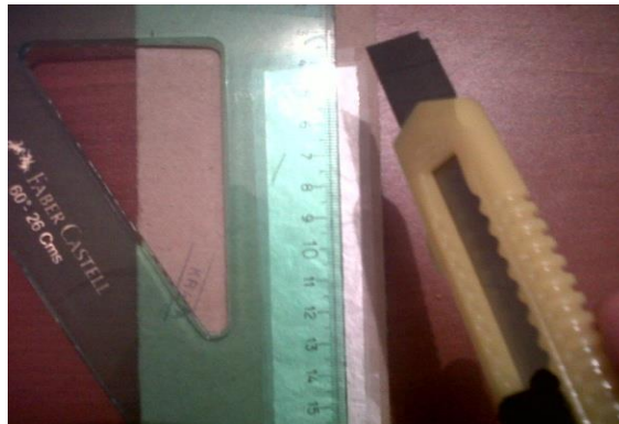
Figura 5.14 Corte de la cinta , ancho de 4(m.m)
