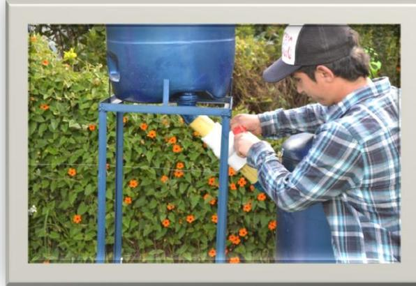
Cuando la mezcla haya pasado en su totalidad, se cierra la válvula para evitar la entrada de oxígeno, dando paso a la fermentación anaerobia; el tiempo de retención calculado para la carga es de 15 días aproximadamente.
