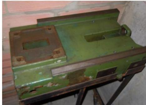
Figura 80. Partes corroídas.
