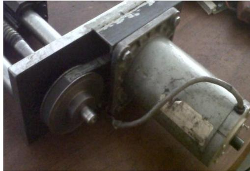
Figura 86. Motores de los ejes.
