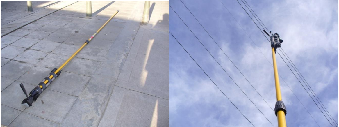
Figura 14: Mono-pie de 4 metros de altura, acoplado al sonómetro
