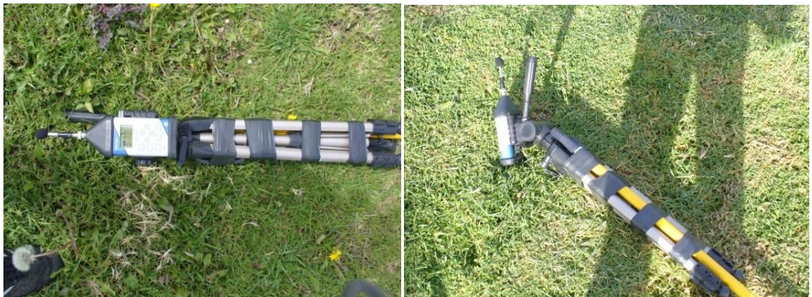
Figura 13: Sonómetro con su respectivo trípode acoplado al mono-pie.
