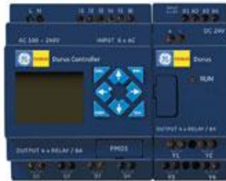
Figura 105. Detalle controlador DURUS.
