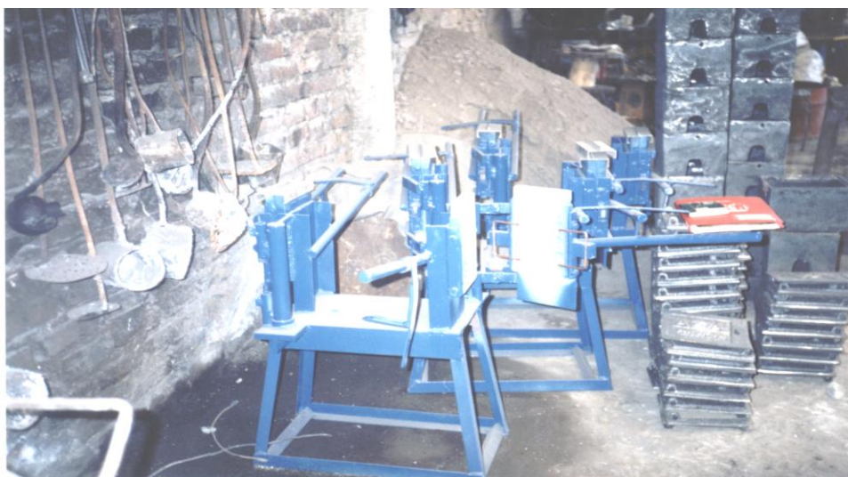
Figura 7. Batería de coquillas empresa FUNDIMETALES.
