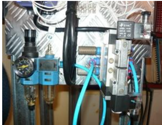
Figura 88. Unidad de mantenimiento y control con válvula electro neumática 5/3.
