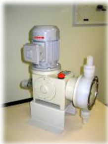
Figura 13. Bomba dosificadora de alimentos.
