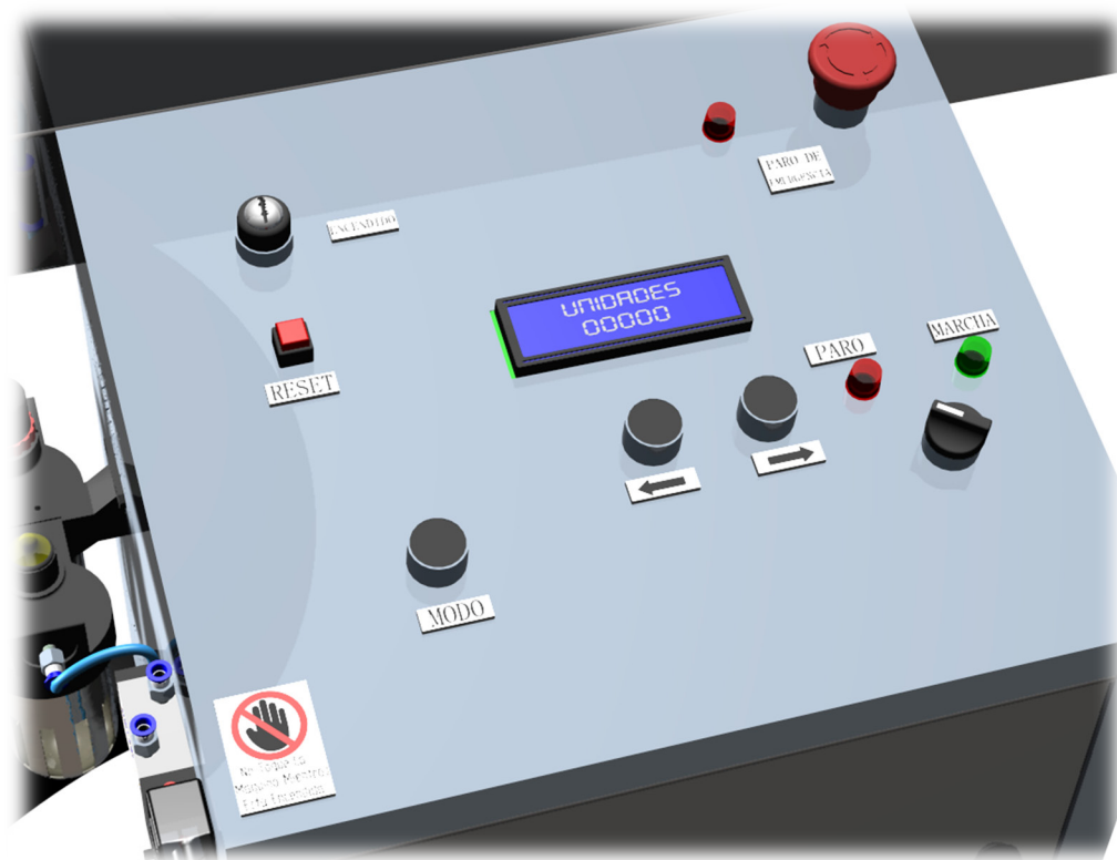
Figura 44. Panel del tablero de control.
