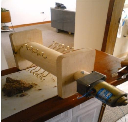
Este modelo básicamente se compone de un eje acoplado a un motoreductor con 4 hileras (cada una a 90°) de ganchos curvos, entre sus especificaciones se encuentra:
