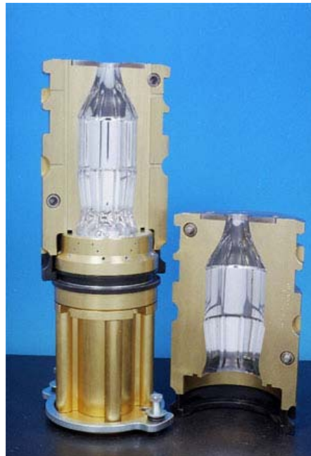
Figura 10: Molde terminado con la forma de una botella.
