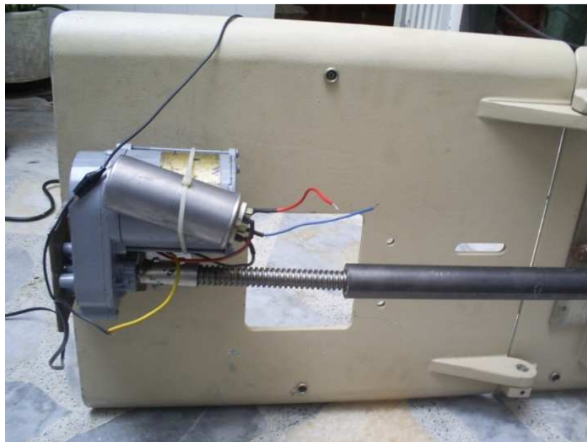
Figura 39 Motor utilizado para el movimiento espaldas/pies
