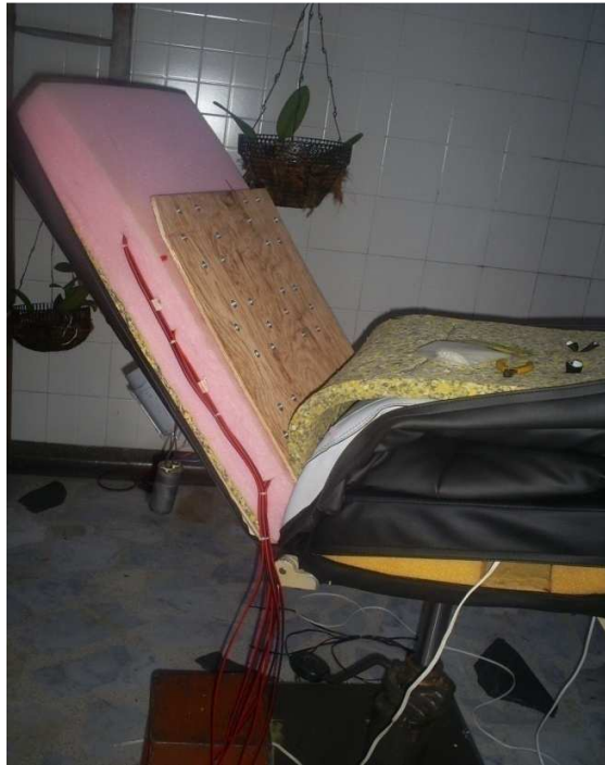
Figura 44. Disposición Motores En La Silla Masajeadora (B)
