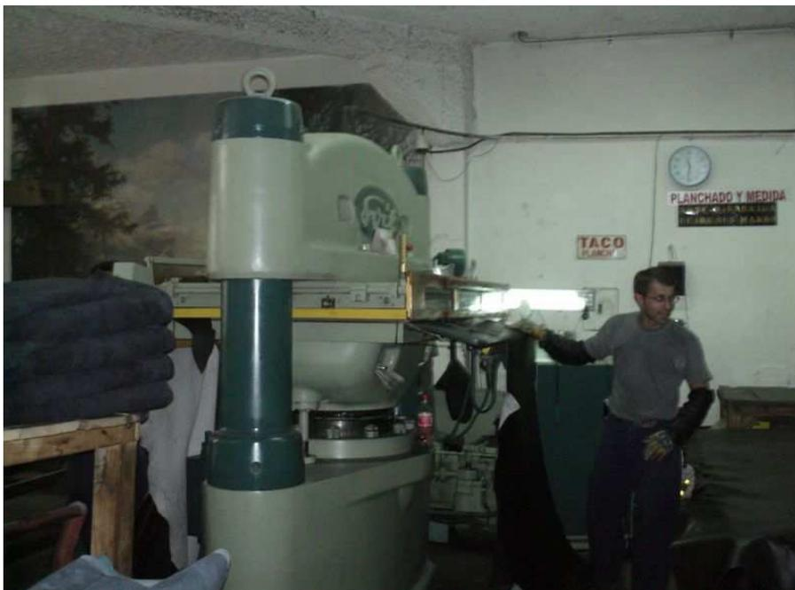
Foto 7. Calibrada del cuero que se utiliza para suelas de calzado
