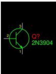
El funcionamiento del transistor es muy sencillo, el microcontrolador manda una señal de 5 Vdc a la base del transistor entonces este conecta el colector con el emisor y mantiene la corriente necesaria para activar el revelo mientras la base reciba los 5Vdc.
