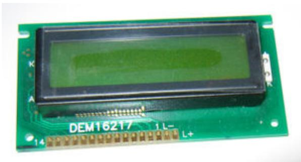
Se trata de un sistema eléctrico de presentación de datos formado por 2 capas conductoras transparentes y en medio un material especial cristalino (cristal líquido) que tienen la capacidad de orientar la luz a su paso.
