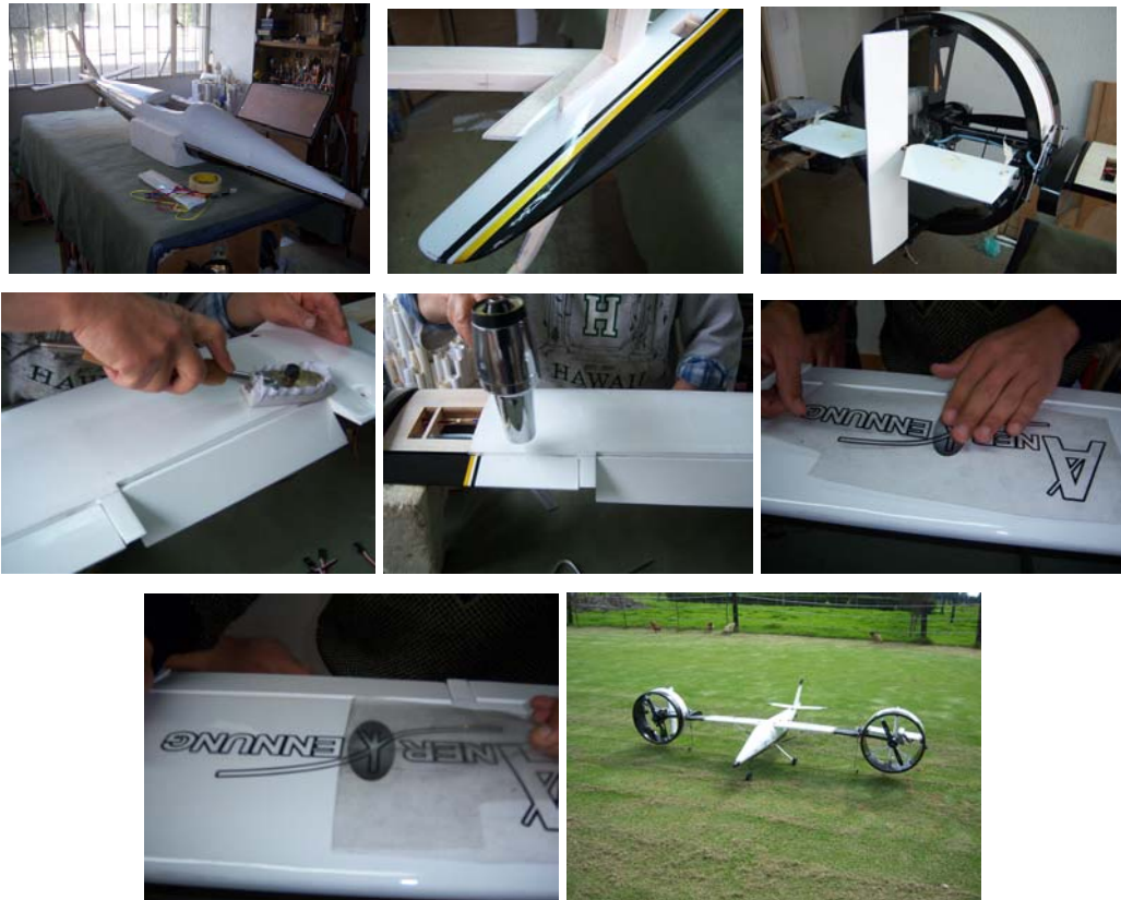
Figura 211. Proceso de monocoteado, acabado y ensamble final.
