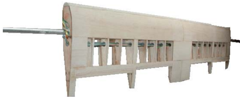
Figura 188. Estructura del ala terminada.
