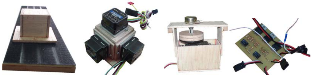
Figura 208. Componentes adicionales en el avión gyros y potenciómetro.
