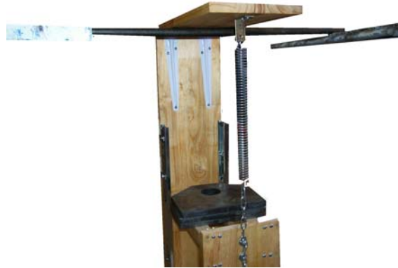
Figura 53. Banco de pruebas colgado en estructura para medir el "K" del resorte.
