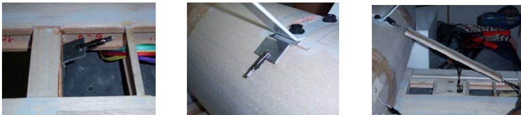
Figura 209. Ubicación de los Struts entre las alas y fuselaje.
