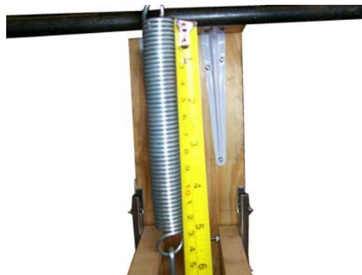
Figura 55. Medición de la elongación del resorte.
