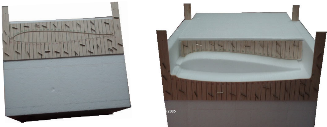
Figura 192. Corte de la silla del ala.
