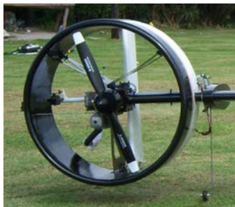
Figura 212. Ensamble de ducted fan.
