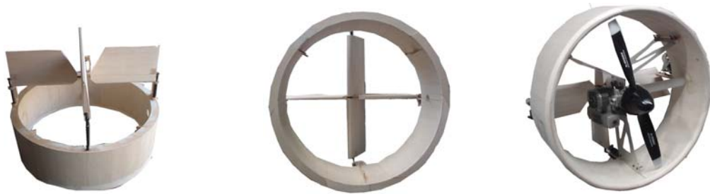
Figura 203. Ensamble del motor en el ducted fan.
