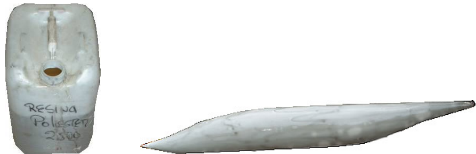
Figura 183. Molde del fuselaje cubierto con resina poliéster.
