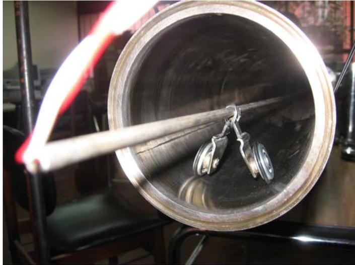
Imagen 7 Dispositivo para medir coeficiente de absorción
