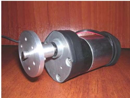
La figura 131 muestra una pieza en forma de C, fabricada en aluminio, la cual cumple dos funciones importantes, permitir que el motoreductor coincida con el eje de la rueda y que a su vez la rueda reciba el movimiento transmitido por ella.
