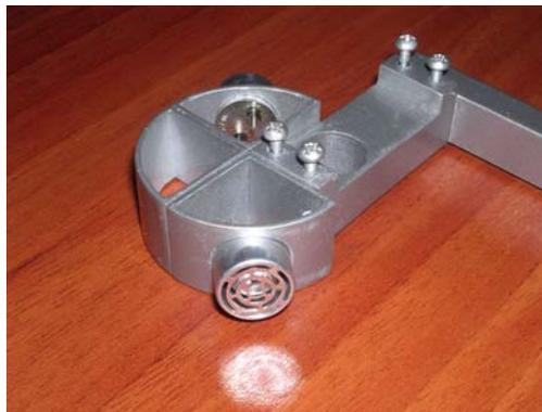
En la siguiente imagen se puede apreciar el Rocker en aluminio, el cual contiene el soporte del servomotor, y el soporte de los sensores.
