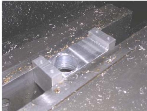
Figura 126.-Soporte del sensor de ultrasonido
