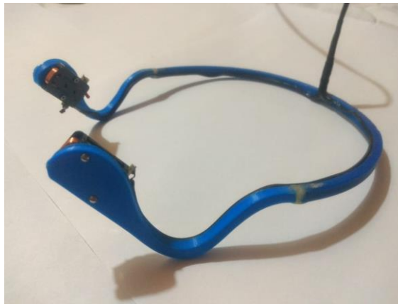
Figura 4-27: Impresión 3D y ensamblaje de la diadema con los transductores acoplados.
