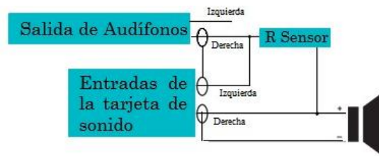
Figura 4-4: Diagrama de conexión para medición de impedancia y parámetros TS (Thiele-Small)
