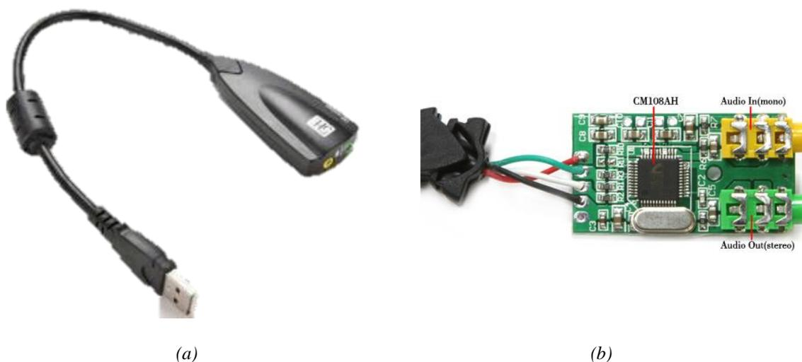
Figura 25. (a) Módulo adaptador de audio por protocolo USB. (b) Componentes principales presentes en el adaptador de audio.
