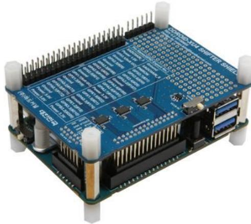
Figura 17. Módulo Shifter Shield acoplado al ODROID XU4.
