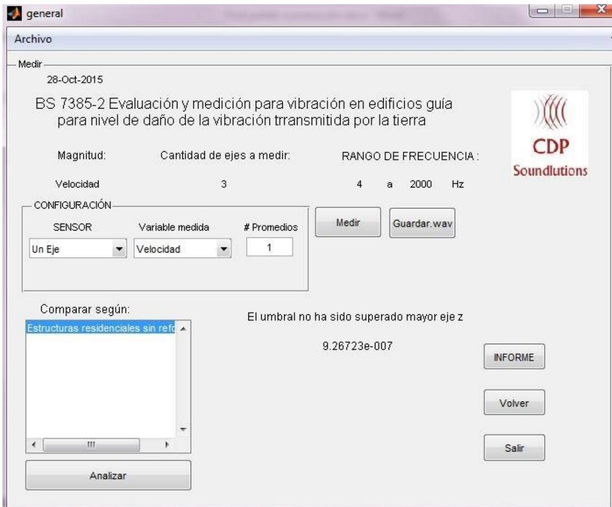
Ilustración 43 Resultado de la medición en el VCDP Fuente: Propia
