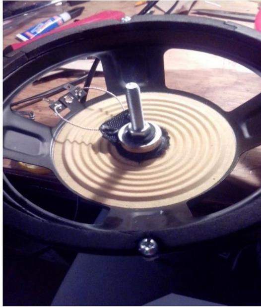
Ilustración 29 Parlante sin cono y con el sistema acoplado. Fuente: Propia
