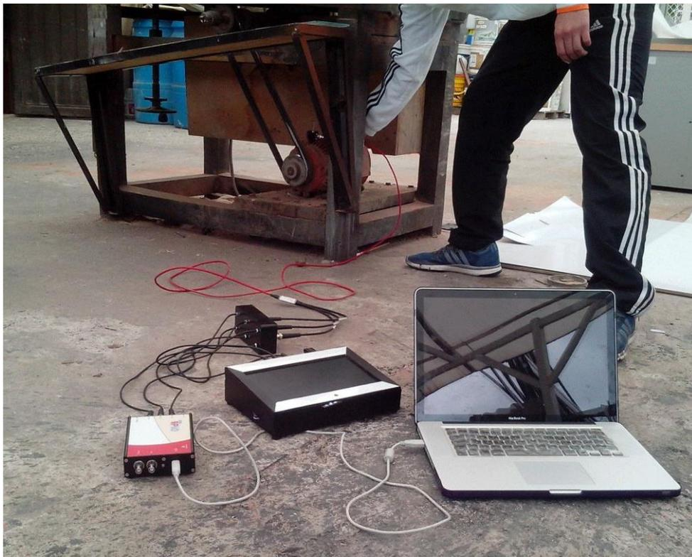
Ilustración 57 Medición para normativa en máquinas ISO 10816 fuente: propia
