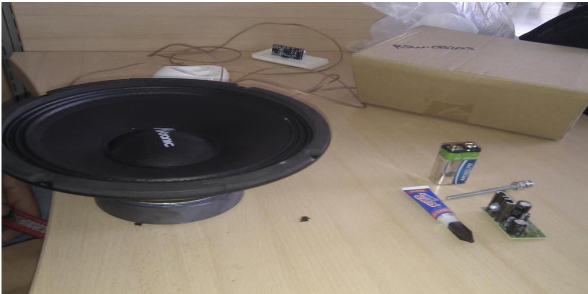
Ilustración 28 Parlante utilizado para implementar el shaker. Fuente: Propia
