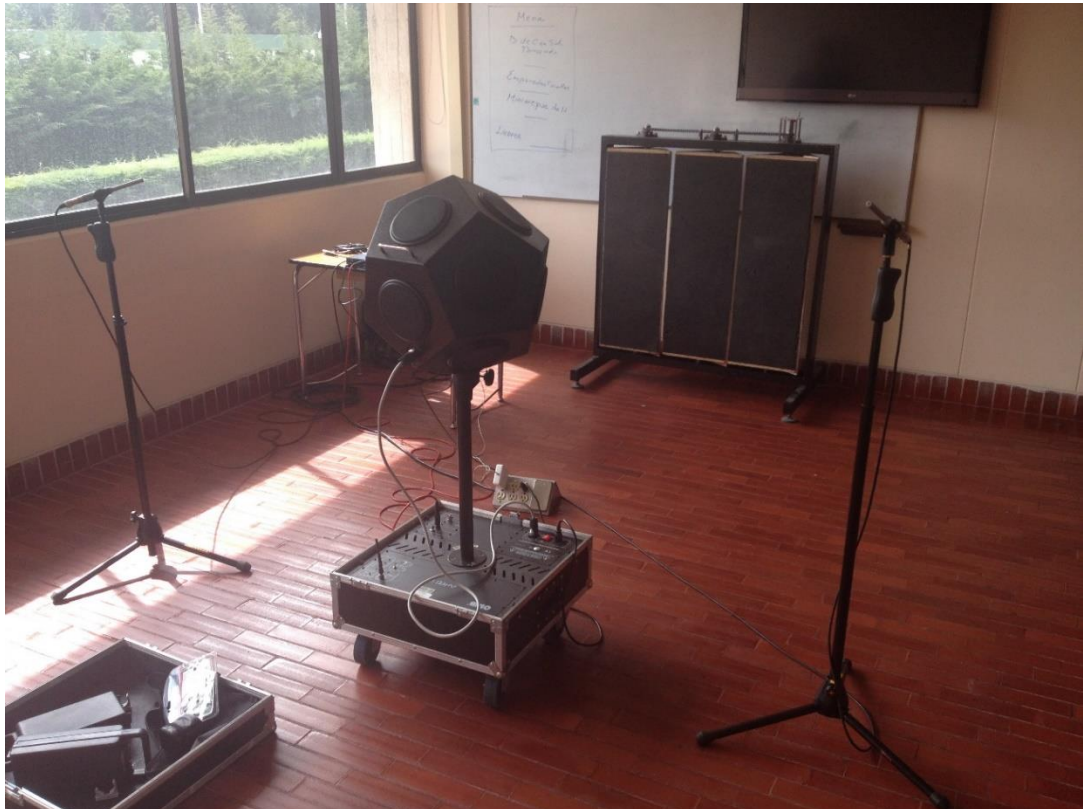
Figura 49. Mediciones de tiempo de reverberación del prototipo de panel para acústica variable
