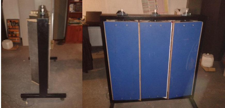
Figura 33. Montaje completo de los paneles en la estructura de apoyo en diferentes perspectivas a) estructura metálica de perfil b) estructura metálica vista frontal
