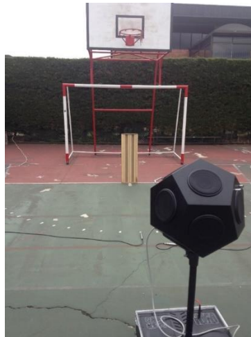
Figura 41. Medición superficie difusora del panel difusor a 0°
