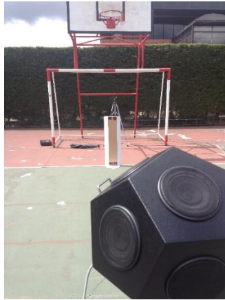
Figura 41. Medición superficie difusora del panel difusor a 0°
